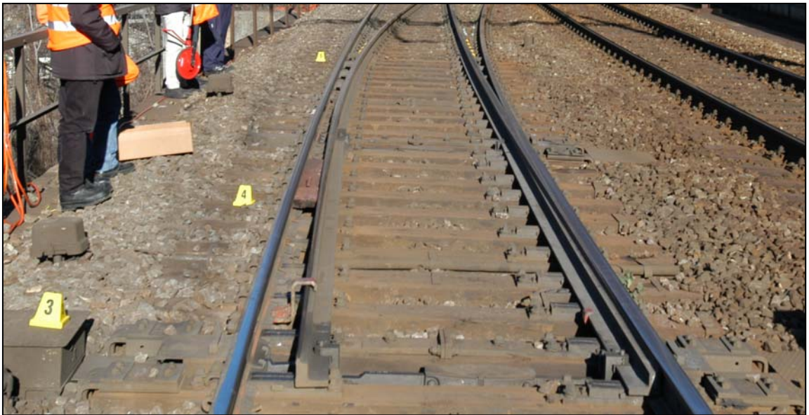
Spurenbild Fall 1 (Weiche nach Unfall in gerader Stellung verschraubt)
