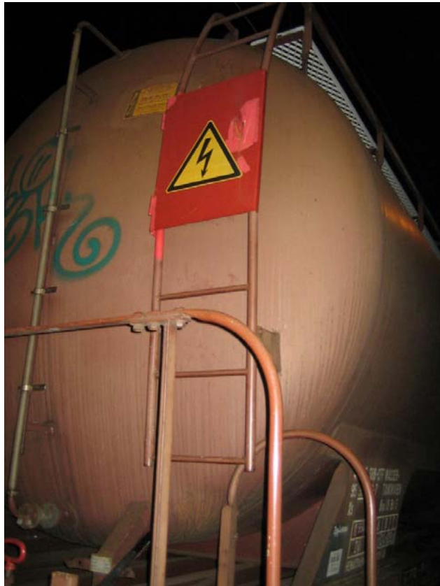
Bremsplattform mit Leiter, Abdeckung und Warnschilder.
