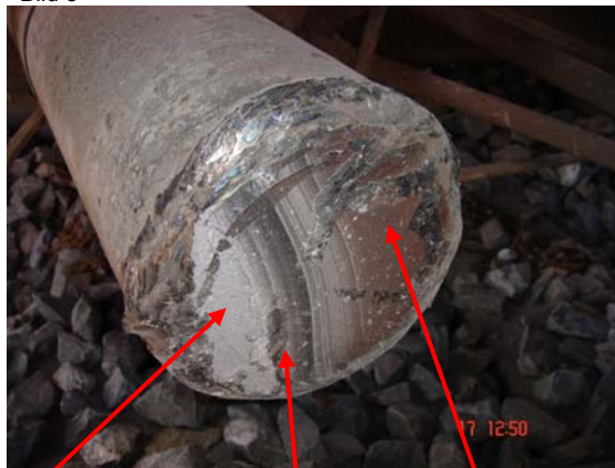
Restbruch Übergang Schwingbruch/Restbruch Schwingbruch
