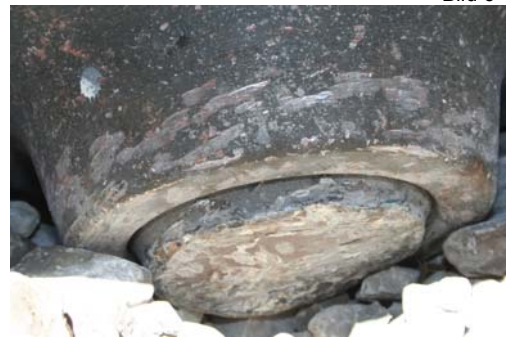
Abgebrochene Achse (Bild 5) und Radscheibe mit Achsschenkel (Bild 6)
