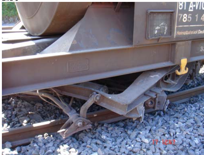
Entgleistes Drehgestell (Wagen Nr. 3381 785 1 434-9)
