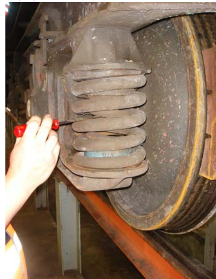
Defekte innere Feder (Wagen Nr. 3381 784 9 437-7)
