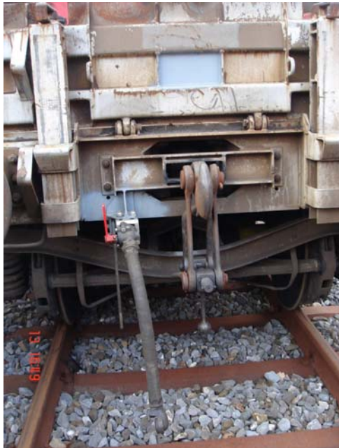
Der Bremshahn am Res Seite Sargans war geschlossen, der Luftschlauch nicht in der vorgesehen Halterung.
