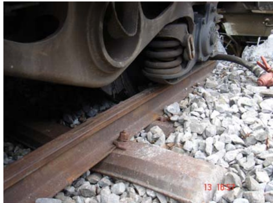
Die Hauptbrensleitung am Res war hinter dem Bremshahn abgebrochen.
