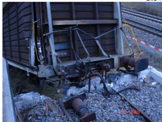
Die Handbremse des Hbis war nicht angezogen, Der Bremshahn an der Hauptluftleitung geöffnet.
